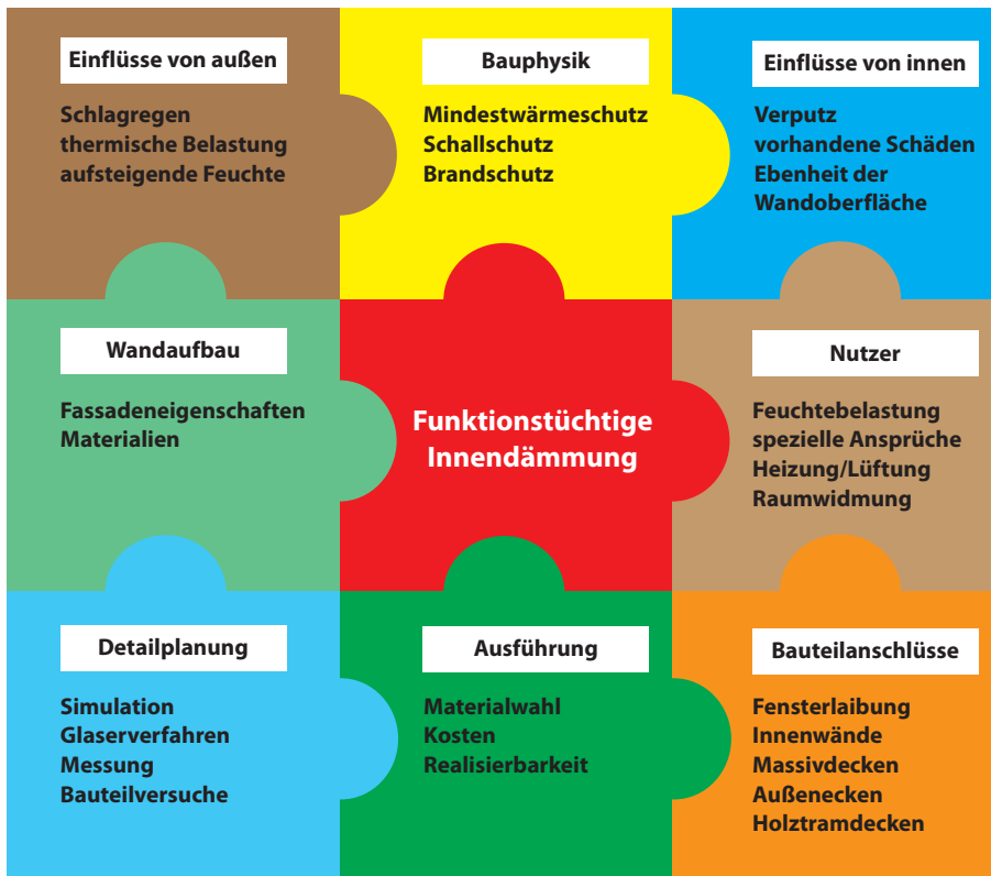
Abb. 1.10: Visualisierung der Einflussgrößen auf die Auswahl von Innendämmsystemen (Quelle: Wegerer, 2010)
